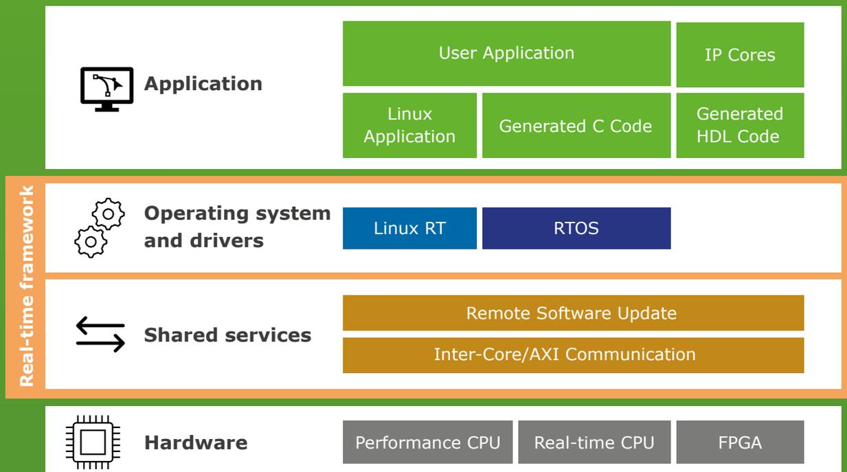
Durch den Einsatz unseres **Kernel-Patches**, welcher speziell für diese Plattform entwickelt wurde, können wir einen stabilen 10kHz Takt auf den Echtzeitkernen sicherstellen. Gemessen wurde dieser mit einem komplexen industriellen Simulink®-Regelalgorithmus.
